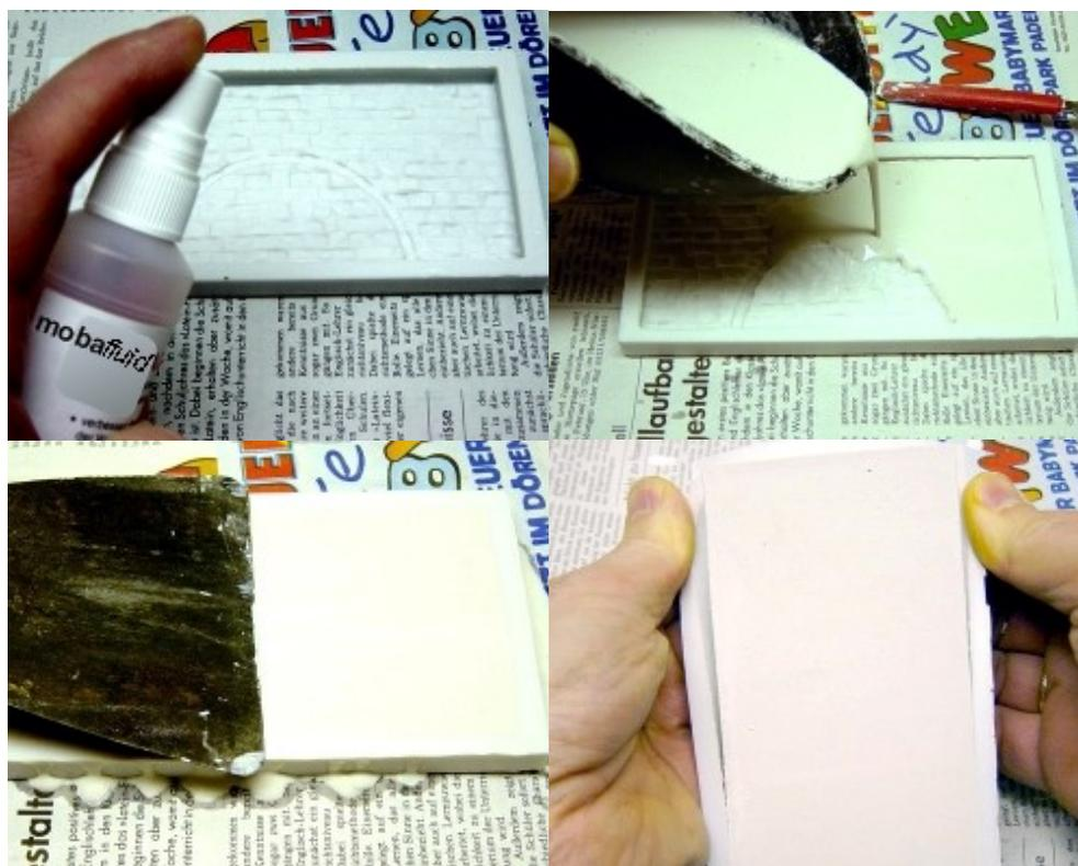
**Fotos oben: So geht´s: Form eben auslegen, Netzmittel gegen Blasenbildung, gießen, abstreifen und ausformen**
