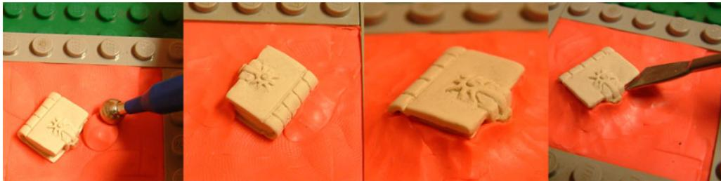
Jetzt wird das Ur-Modell bis zur Schnittkante eingebettet. Hierbei ist Sorgfalt und sauberes arbeiten ein Muss, sonst werden Knetreste und Krümel später mit abgeformt! Mit spitzen Werkzeugen z.B. Zahnstocher auch kleinste Reste herausschaben. Die Schnittkante muss sauber, glatt und unbedingt dicht anliegend sein!
